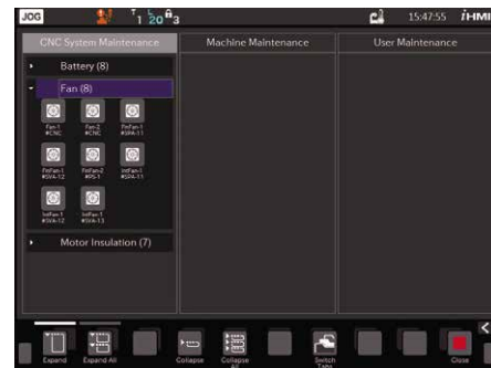
Tela de gerenciamento de informações de manutenção
