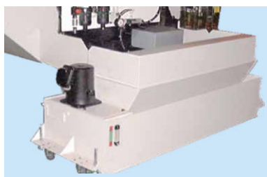
Unidade de refrigeração (tanque)
