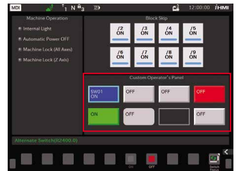
Painel de controle personalizado
