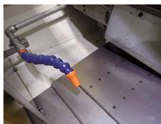
Unidade de refrigeração com descarga de cavacos (com pistola de óleo)
