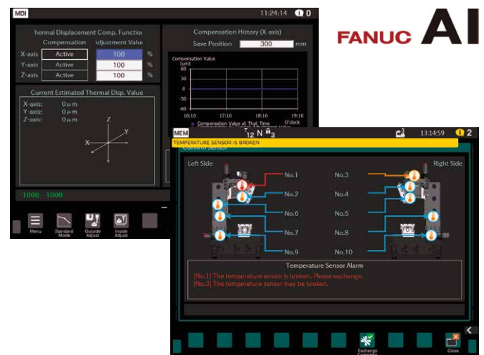
Compensação de deslocamento térmico de IA
